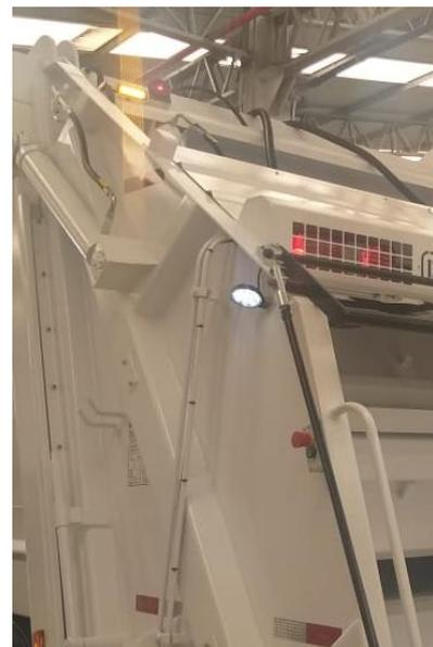
**Plataforma:** Revestido com chapa vazada (expandida), com capacidade para 04 operadores, localizada a aproximadamente 500mm do solo, tendo 420 mm de profundidade por toda a largura do veículo. *(atende item 8.1 e 8.2 da NBR 14599)*
