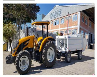
Coletor novo, de fabricação nacional, rebocável por trator, com capacidade para 04 m³ de lixo compactado, sistema de carga traseiro. Chassi tipo monobloco com quatro pneus, e eixo cambão para acoplamento ao trator reboque.
